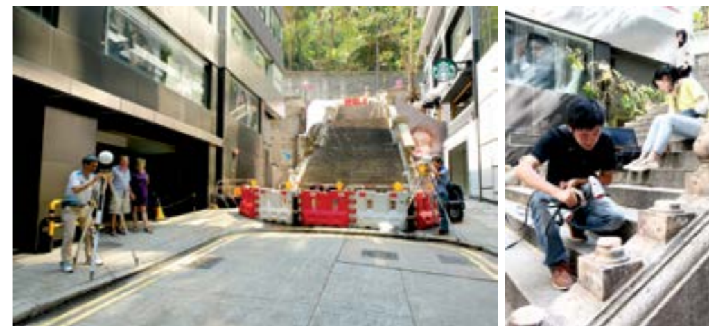
圖9 古蹟辦的三維掃描小組使用地面激光掃描儀(左)和手提式三維激光掃描儀(右)在現場進行三維掃描。
