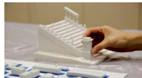
圖13 運用三維打印技術製作已編號花崗石碎件的微縮模型，並在古蹟辦的辦公室重新併合。
