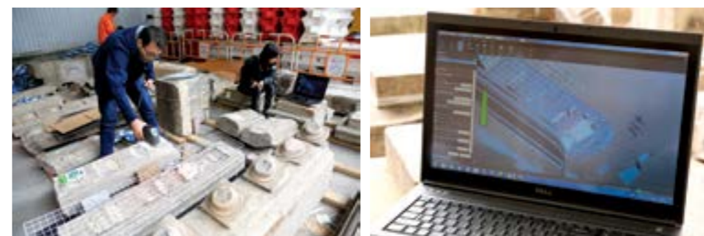
圖10 對花崗石碎件進行掃描，以獲取其形狀和尺寸等準確資料。
