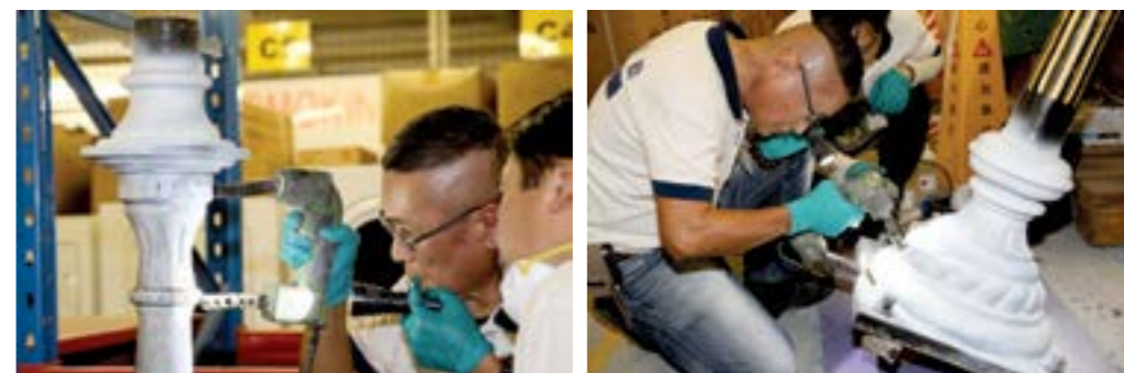
圖21 專業承辦商在煤氣公司倉庫對兩支鑄鐵燈柱進行非破壞性檢測。
